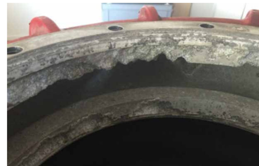
Auf den Bilder gut ersichtlich, die Frass- und Kavitations-Spuren!
